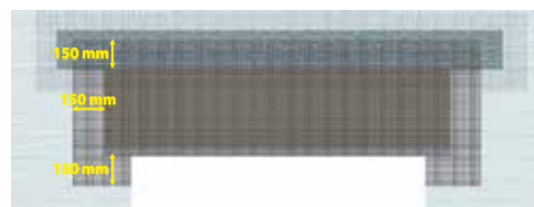
Renforcement de l'enduit jusqu'à 2500 mm
