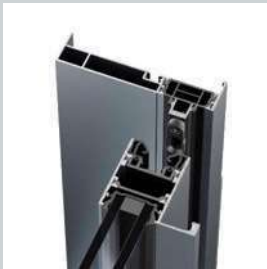
Système de fermeture renforcée par gâche filante toute hauteur fixé au dormant pour verrouillage jusqu'à 4 points
