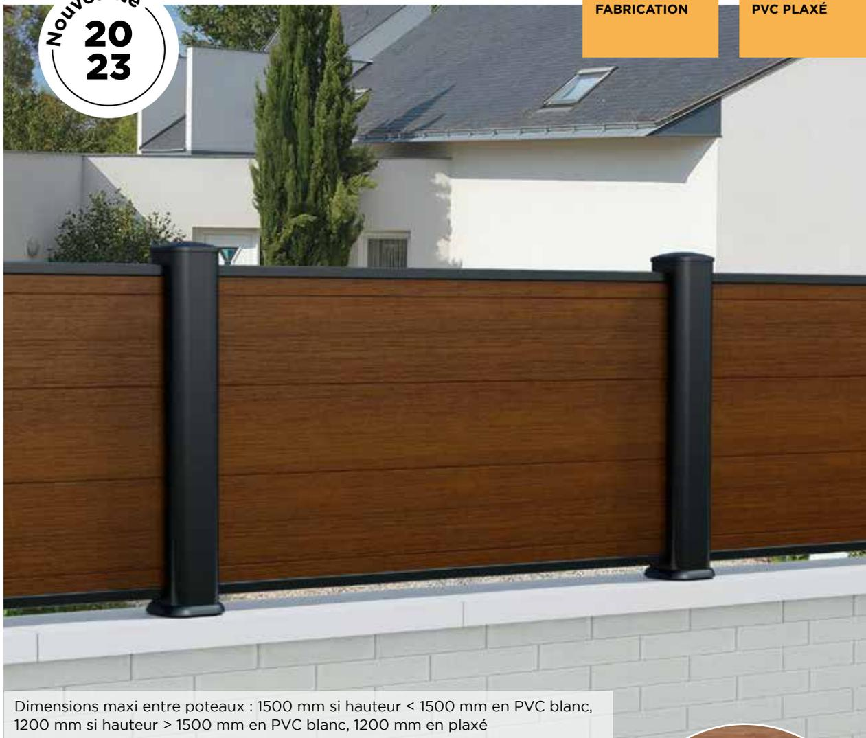
Dimensions maxi entre poteaux : 1500 mm si hauteur < 1500 mm en PVC blanc, 1200 mm si hauteur > 1500 mm en PVC blanc, 1200 mm en plaxé
