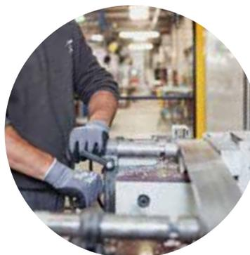
Chez DC, tous nos portails sont fabriqués à la main de A à Z. L'opération de cintrage est réalisée sur une cintreuse à rouleaux par un serrurier. Il règle la machine selon les tolérances préétablies au modèle et à sa largeur. C'est aussi ça le sur-mesure !
